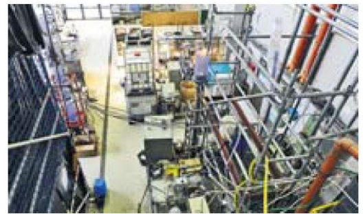
In dieser Anlage wird Urin zu Dünger aufbereitet.
