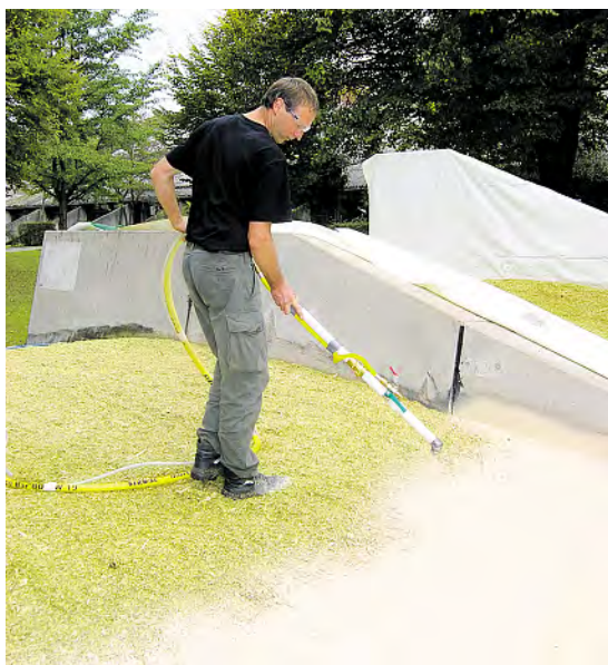
Auftragen der Latex-Sonnenblumenöl-Suspension auf einer Testanlage. Fotos (2): TFZ, Straubing
