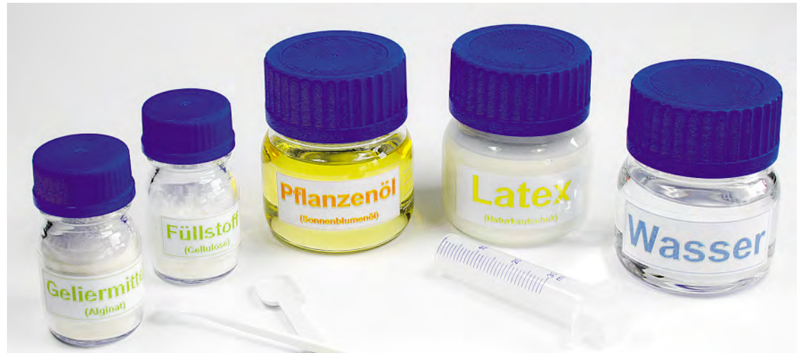
Bestandteile der von der TFZ in Straubing entwickelten Folie aus nachwachsenden Rohstoffen.
