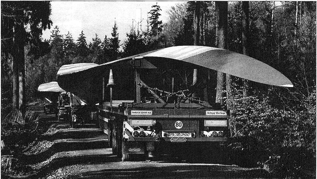
Schwierig ist der Transport der langen Rotorblätter und Turmsegmente über schmale, gewundene Waldwege.
