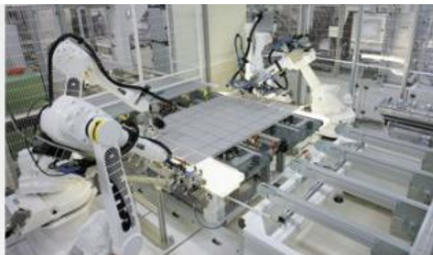
In der Modulproduktion: Die Querverschaltung der Strings, der in Reihe geschalteten Solarzellen, erfolgt vollautomatisch. (Quelle: Conergy)
