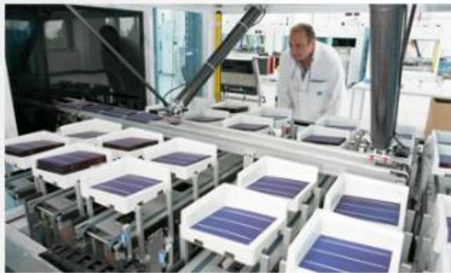
Nur Zuschauer: Der Spezialgreifer sortiert die Solarzellen blitzschnell in bis zu 21 verschiedene Qualitätskategorien. Der Mensch braucht nur zuzuschauen. (Quelle: Conergy)
