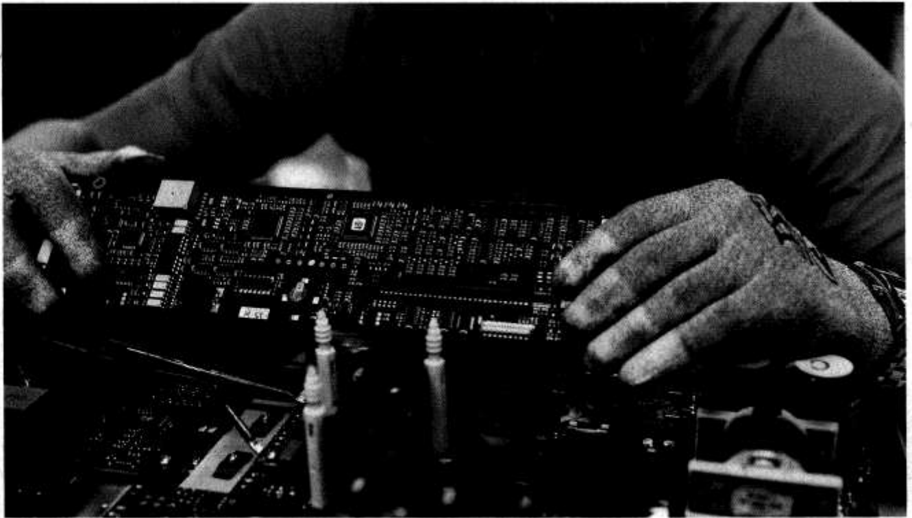
Konzentrierte Arbeit: Ein Mitarbeiter des Schweizer Wechselrichter-Spezialisten Solarmax montiert einen so genannten String-Inverter.
