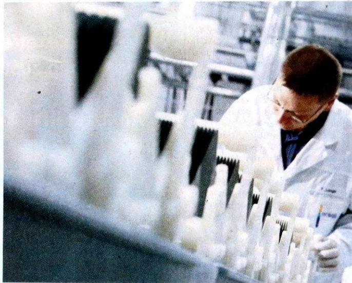
Ein Ersol-Mitarbeiter bereitet Wafer für die Diffusionsanlage vor. Bei 800 bis 900 Grad Celsius diffundieren hier Phosphoratome in die Oberfläche der Siliziumscheiben
