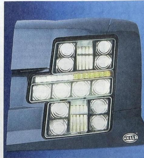
**Ganz in LED-Technik:** ein Scheinwerfer-Prototyp von Hella. Das aus zweimal fünf LED-Modulen mit insgesamt 16 LED (Licht emittierenden Dioden) bestehende Abblendlicht ist im oberen und unteren Bereich des Scheinwerfers positioniert. Als ergänzendes Designelement dazu befinden sich dazwischen vier LED-Module für das Fernlicht. Oberhalb dieser Zeile befinden sich die Funktionen Tagfahrlicht (in gedimmter Form als Positionslicht) und Blinklicht (jeweils sieben LED). Foto: Hella
