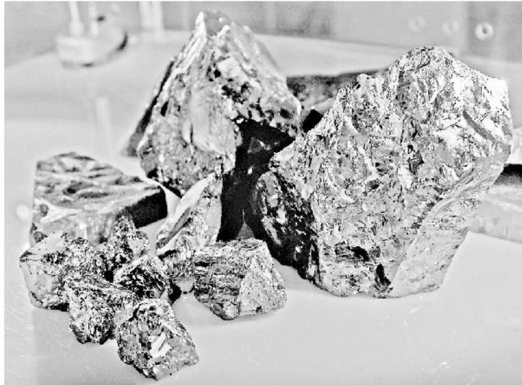
Der rare Stoff, aus dem die Zellen sind: Gereinigtes Silizium dient als Rohstoff für die Solarbranche. Nun wollen Techniker den Engpass beheben.
