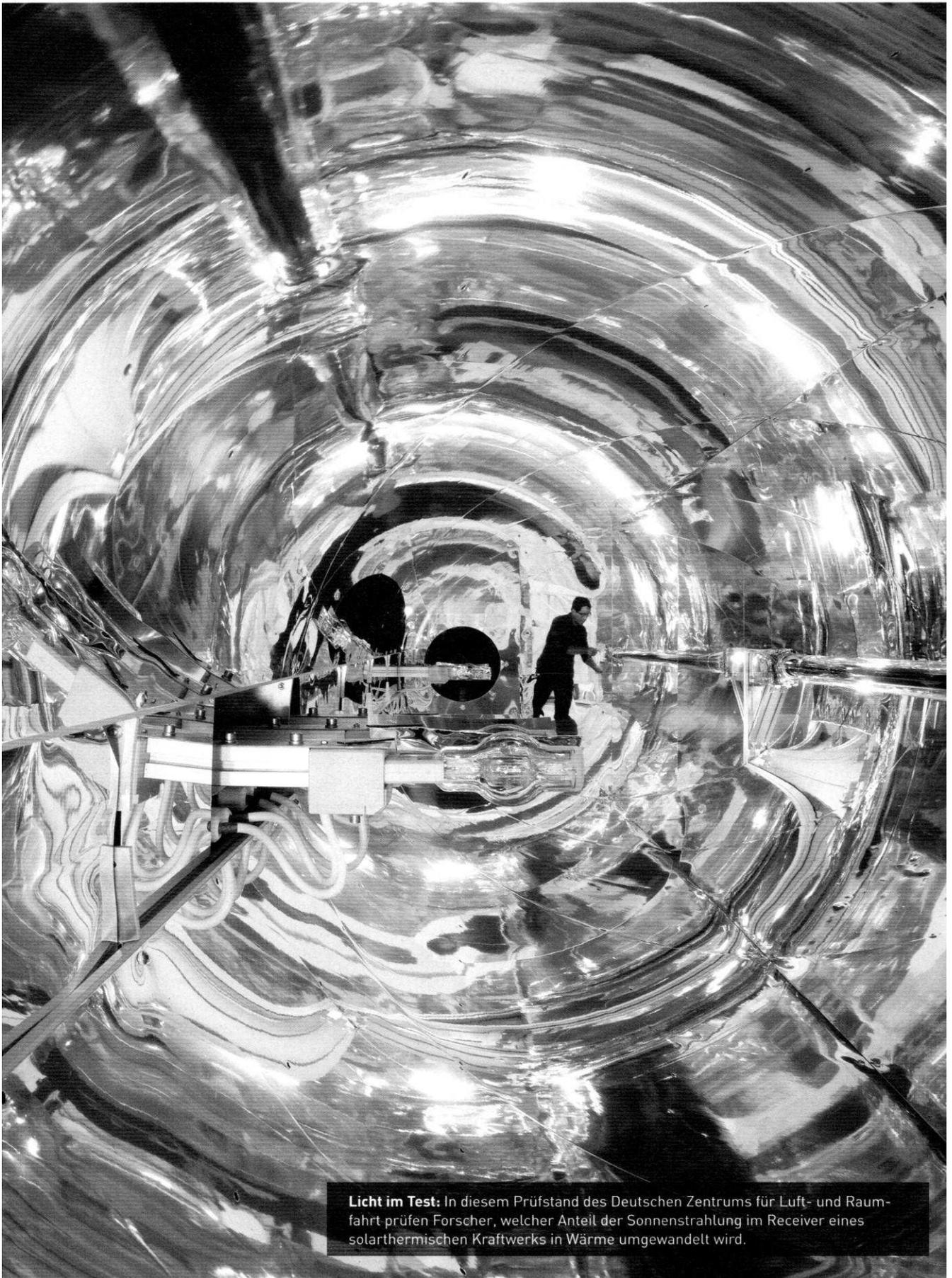
**Licht im Test:** In diesem Prüfstand des Deutschen Zentrums für Luft- und Raumfahrt prüfen Forscher, welcher Anteil der Sonnenstrahlung im Receiver eines solarthermischen Kraftwerks in Wärme umgewandelt wird.
