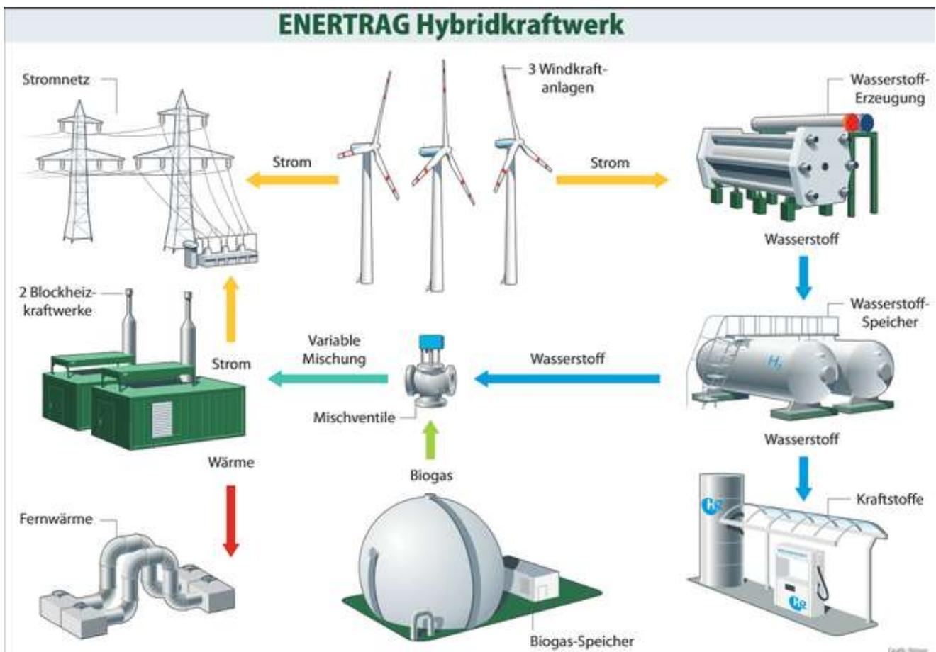
Das Energieunternehmen Enertrag spart sich in seinem Prenzlauer Hybridkraftwerk die Methanisierung und produziert dort neben Strom und Wärme nur Wasserstoff. Grafik: ©Enertrag/Römer
