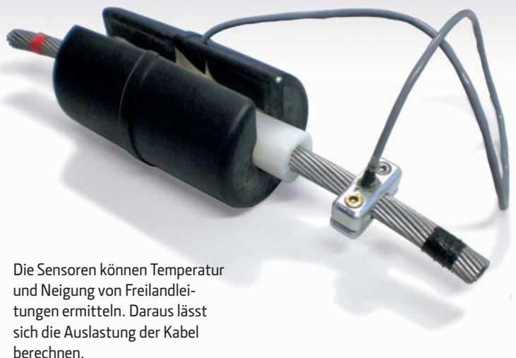
Die Sensoren können Temperatur und Neigung von Freilandleitungen ermitteln. Daraus lässt sich die Auslastung der Kabel berechnen.
