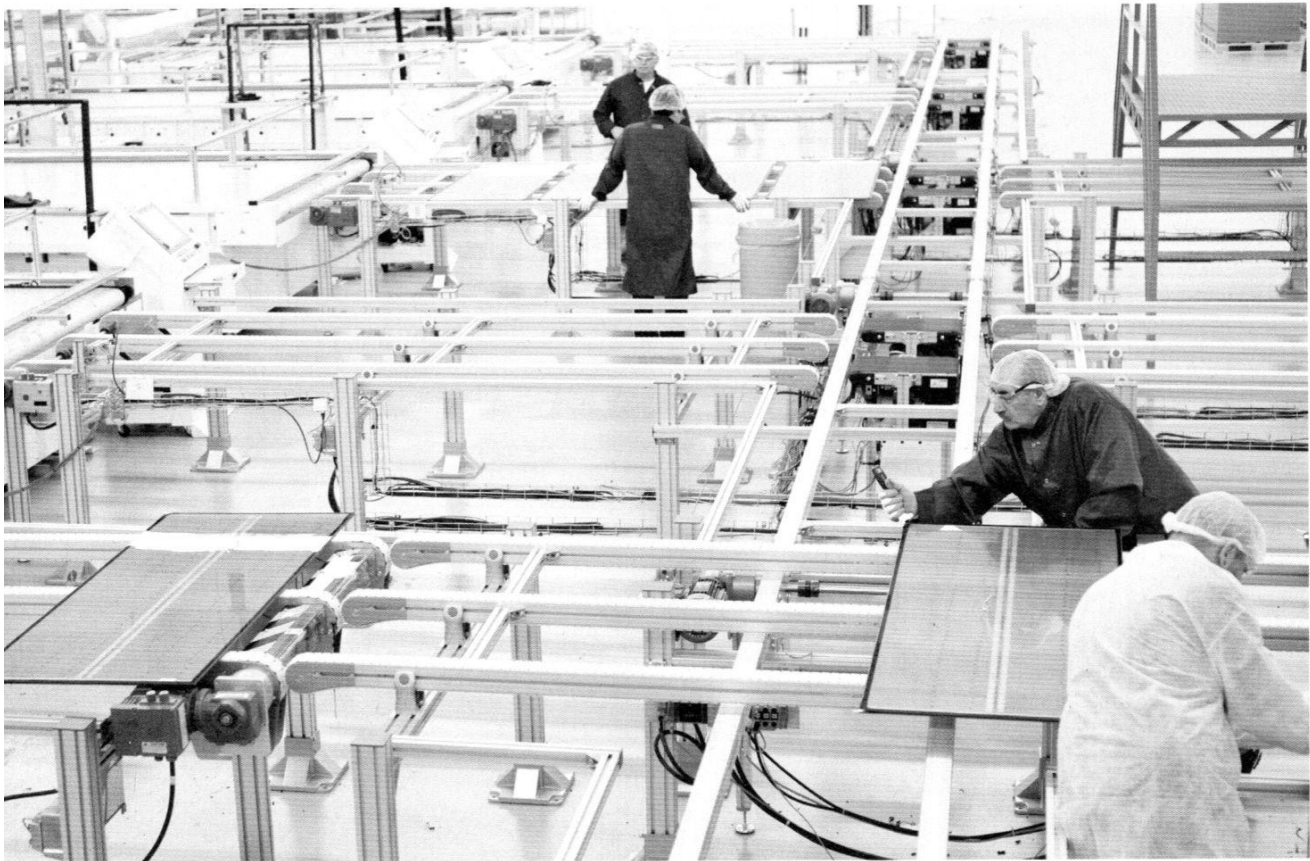
Beachtliche Energieausbeute: Die Cigs-Folien des Solarherstellers Miasolé in Kalifornien erreichen einen Wirkungsgrad von 14 Prozent.
