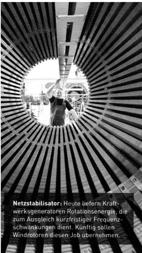
**Netzstabilisator:** Heute liefern Kraftwerksgeneratoren Rotationsenergie, die zum Ausgleich kurzfristiger Frequenzschwankungen dient. Künftig sollen Windrotoren diesen Job übernehmen.
