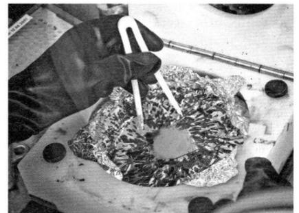
**Der richtige Dreh:** Durch Rotation wird die Oberfläche organischer Solarzellen homogenisiert.
