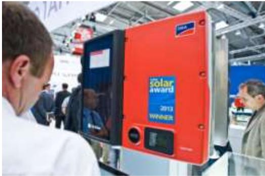
Der neue Sunny Boy Smart Energy: Die Kombination aus Wechselrichter und dem Speicher mit einer Leistung von 2 kW ermöglicht nicht nur eine optimale Eigenverbrauchserhöhung, sondern auch die einfache Nutzung von selbst produziertem Solarstrom. Bild: SMA
