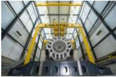
Um die Prototypen-Testphase zu verkürzen, bietet das IWES der Industrie seit diesem Frühjahr mit dem „Dynamalab“ in Bremerhaven einen grosstechnischen Prüfstand für Gondeln mit bis zu acht Megawatt Leistung an. ©Bild: Martina Buchholz/IWES
