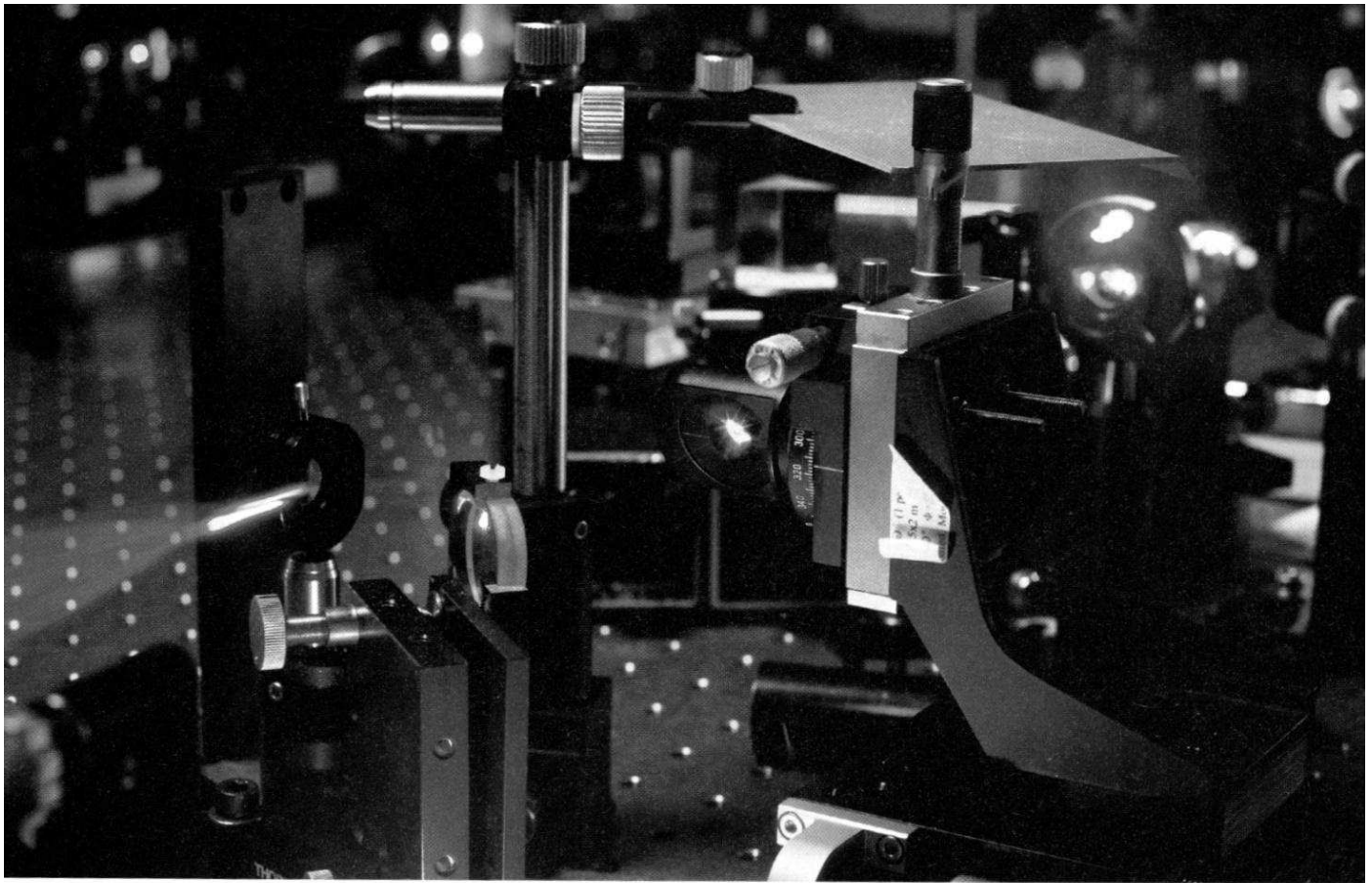
PRÜFSTAND FÜR SONNENFÄNGER: Femto-Sekunden-Laser zur Untersuchung der Zelleigenschaften.
