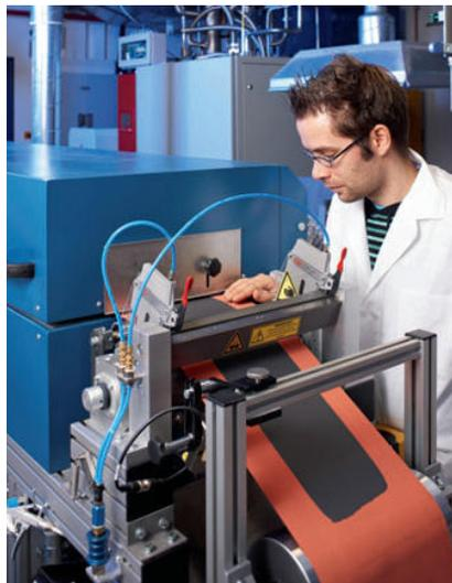
**Entwicklungsfortschritte:** Die neuen Festkörperzellen von Bosch/Seeo könnten die Reichweite von Elektroautos verdoppeln (links). Forscher des Fraunhofer-Instituts IWS haben das Elektroden-Design von Lithium-Schwefel-Batterien optimiert – hier die Beschichtung der Elektroden im Rolle-zu-Rolle-Verfahren.
