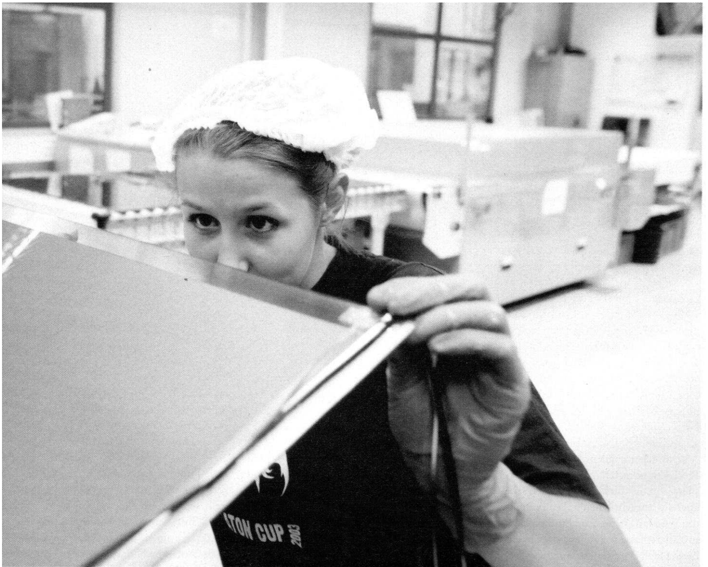
SICHTKONTROLLE: Eine Mitarbeiterin in der Produktion von Würth Solar überprüft die Glasmodule auf Unebenheiten.
