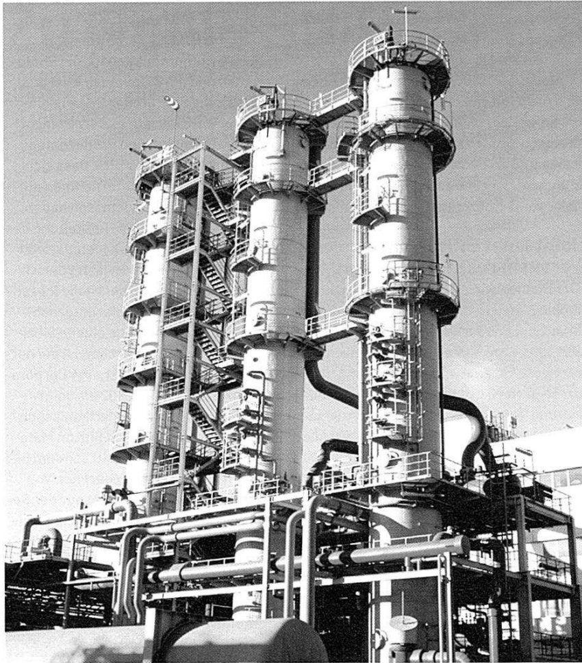
DIE SCHMELZÖFEN: In den Reaktoren wird aus dem Gas Trichlorsilan Silizium gewonnen.
