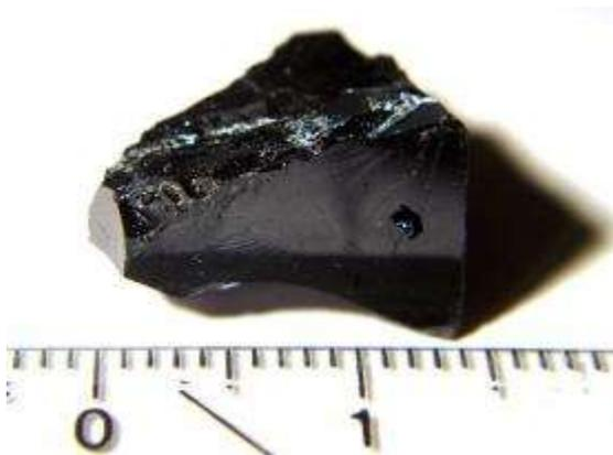
So sieht Cadmiumtellurid in Natura aus. (Foto: [Alchemist-hp](#)/<sup>[1]</sup>[Wikipedia](#)<sup>1</sup>, [CC-Lizenz](#)<sup>[2]</sup>)
