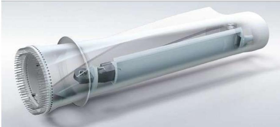
Enercon arbeitet mit den Heizwiderständen an der Rotorblattwurzel, von dort wird die erwärmte Luft mit einem Ventilator durch das Rotorblatt geblasen. So steigt die Temperatur auf 4 Grad, sodass die Eiskristalle zu Wasser werden. Bild: ENERCON gmbH
