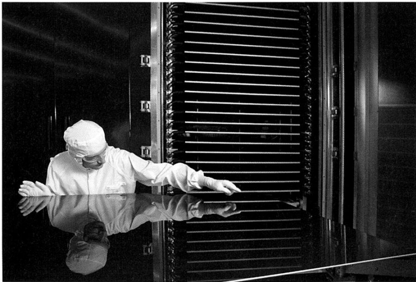
■ Qualitätsprüfung: Ein Mitarbeiter der Berliner Firma Inventux nimmt die Oberfläche eines Moduls aus Dünnschichtsilicium in Augenschein. Bild: Inventux
