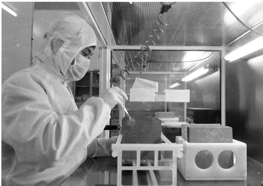
■ Halbleitercheck: Ein Mitarbeiter der chinesischen Firma Suntech Power präpariert die Wafer zur Zellenprozessierung vor. Bild: Suntech Power
