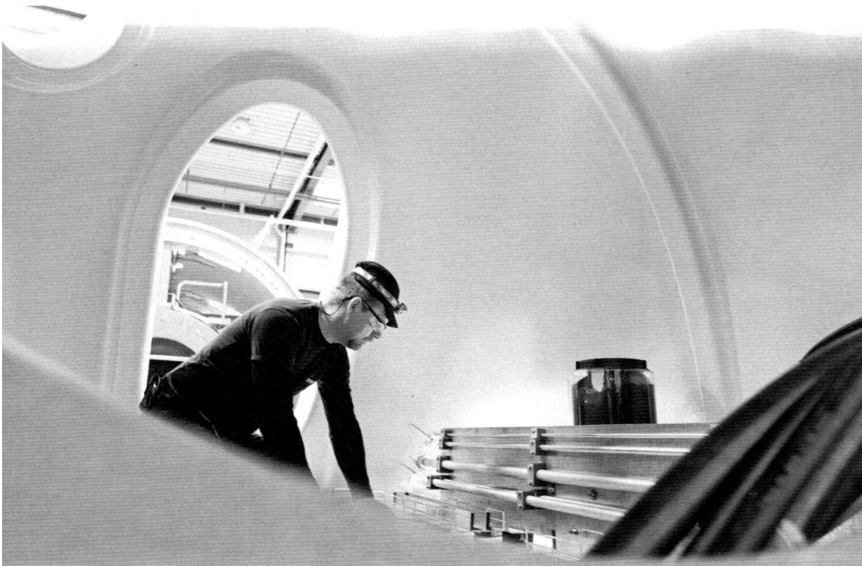
Wichtiges Detail: Hydraulische Systeme sorgen in der Rotornabe für den richtigen Anstellwinkel der Rotorblätter im Wind. Die Montage – hier im Siemens-Werk in Brande – ist eine große Herausforderung.
