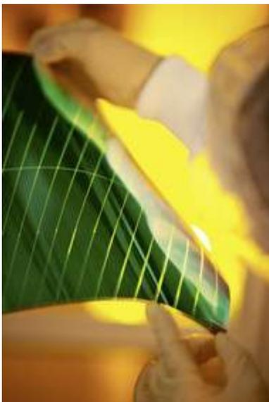
Dünn, leicht und biegsam: Die Firma Heliatek dampft einen fotoaktiven Film hauchdünn auf eine Trägerfolie auf. Die Folie kann somit nahezu unbegrenzt zur Stromproduktion eingesetzt werden. Bild: Heliatek/Tim Deussen, Berlin
