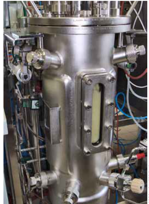
Biologischer Methanisierungs-Behälter der Firma Krajete GmbH im Technikum-Maßstab.
