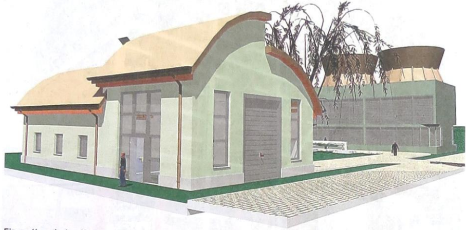
Ein geothermisches Kraftwerk auf Basis des Kalina-Prozesses lässt sich relativ preiswert bauen, weil es bereits mit niedrigen Wassertemperaturen Strom erzeugen kann. Auch auf extrem tiefe Bohrungen kann man verzichten. Foto: Siemens
