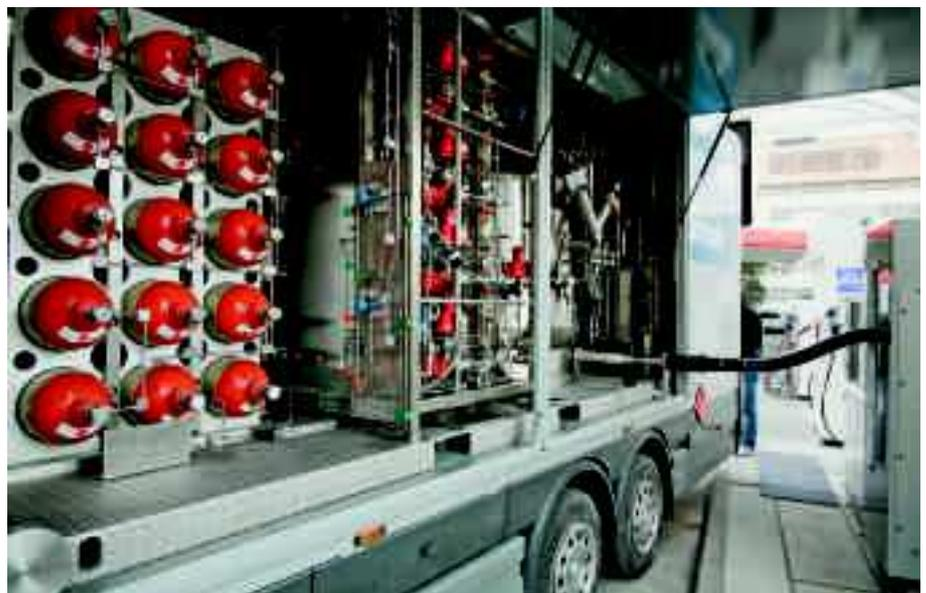
**Spritlieferung: Der Wasserstoff – ein «Abfallprodukt» der Industrie – wird in Flaschen per Lastwagen zu den Tankstellen gebracht.**
