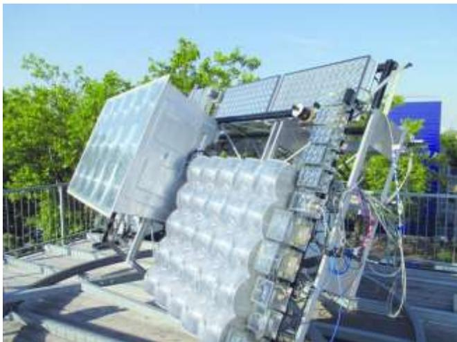
Testtracker für CPV-Systeme auf dem Dach eines Fraunhofer ISE Gebäudes. Ein vergleichbares System wird bei Netra in Indien installiert werden. ©Fraunhofer ISE
