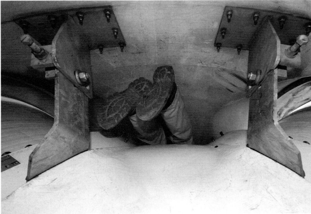
Abgetaucht: Ein Gutachter von 8.2 untersucht das Innere einer V80-Nabe.
