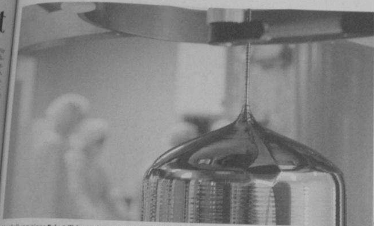
Herstellung eines Reinstiliziumstabs nach dem Tiegelziehverfahren
