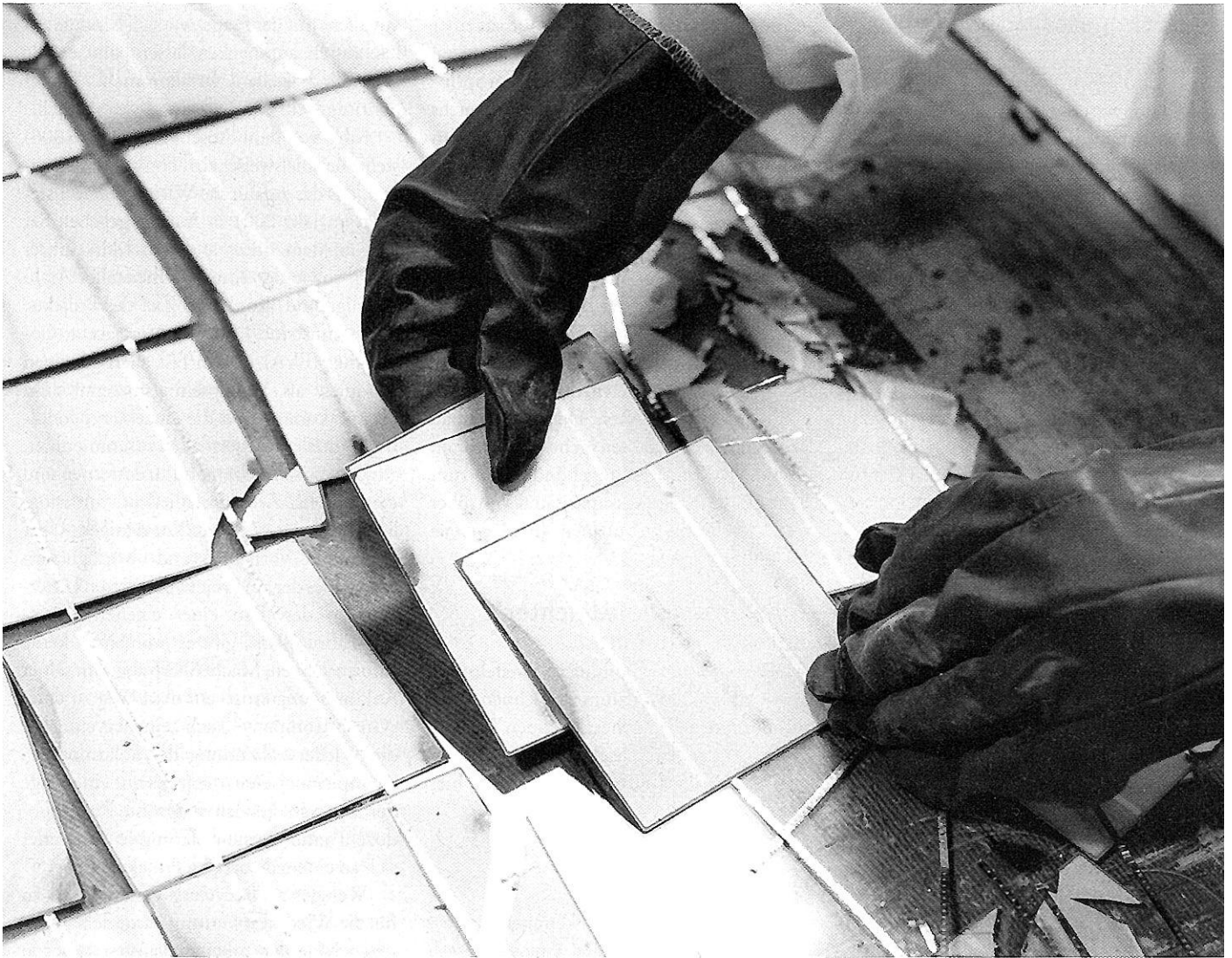
SORTIERUNG: Bevor die WAFER per chemischen Verfahren aus dem Modul herausgelöst werden, sind die Alurahmen zu entfernen.
