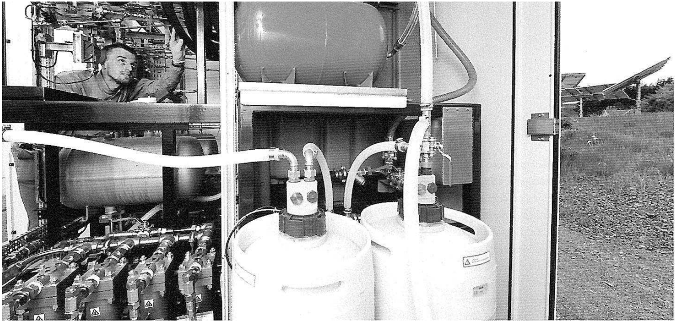
Sonne zu Wasserstoff: Das ZAE Bayern erprobt in Arzberg die Elektrolyse, um Solarspitzen im Stromnetz zu glätten.
