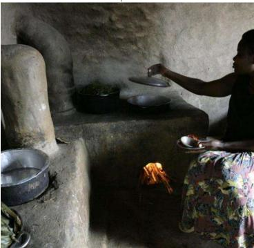
Technische Revolution: Der Herd aus Ton und Blech spart 60 Prozent Brennholz ein und entwickelt kaum Rauch
