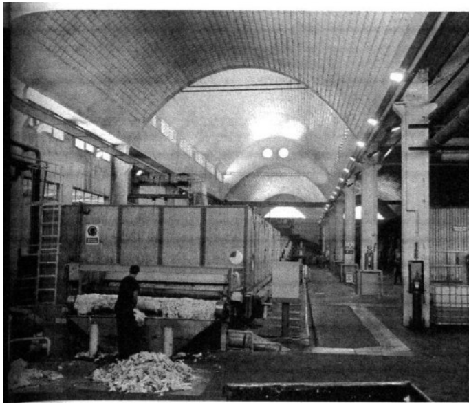
Die Entfettungsanlage bzw. Wollwaschanlage von Lanas Trinidad S.A. zum Auswaschen des Lanolins und anschließender Trocknung.
