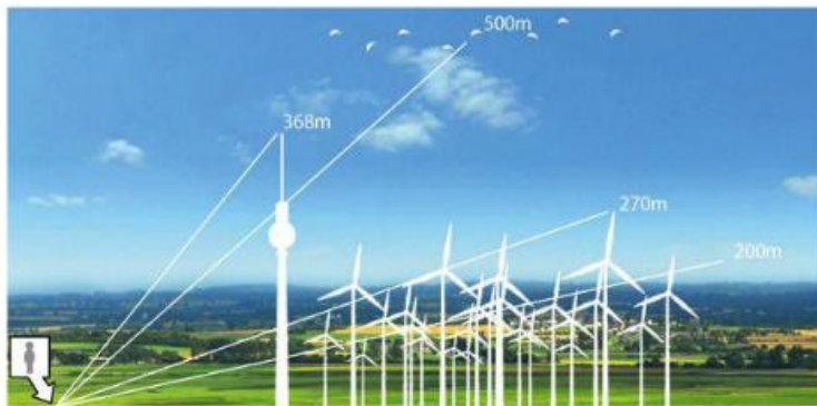
Höher als der Berliner Fernsehturm: Vom Boden aus nahezu unsichtbar, nutzen die Kites den Wind in 500 Metern Höhe. Die Energieausbeute ist dort oben um das Dreifache größer als in der Zone, in der sich die Flügel herkömmlicher Windturbinen drehen.
