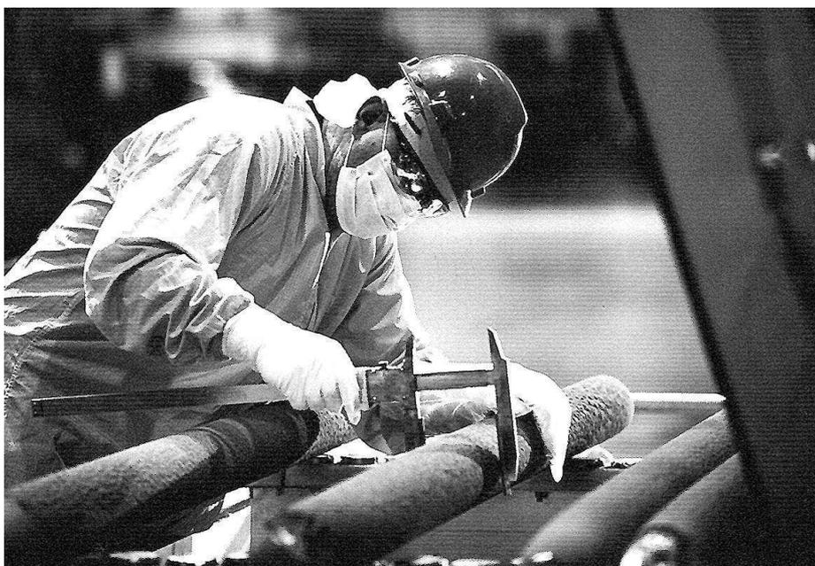
**Frisch aus dem Reaktor:** Siliziumstangen werden vermessen.
