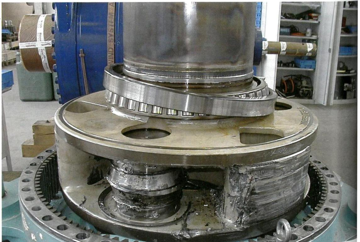
**Nur noch Schrott:** Das Getriebe ist eines der schadenanfälligsten Teile bei Windkraft-Anlagen. Für Schäden am Triebstrang mussten Versicherer im vergangenen Jahr mit mehreren Millionen Euro geradestehen.
