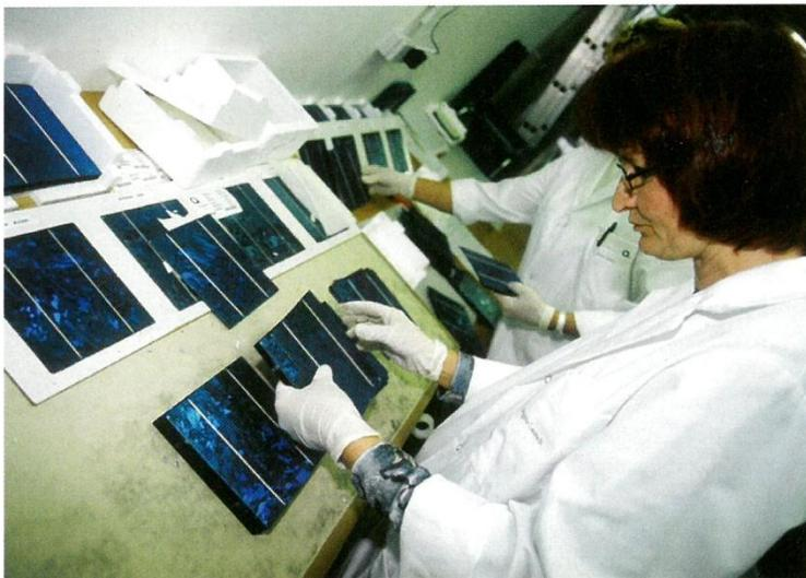
**Zelle für Zelle:** Auch wenn die PV-Produktion immer stärker automatisiert wird, die Qualitätskontrolle – wie hier beim Zellenhersteller Q-Cells – ist meist noch Handarbeit.
