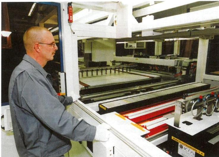
**Bruch-Probe:** Prüfstand für Wafer in der Solar Factory in Freiberg.
