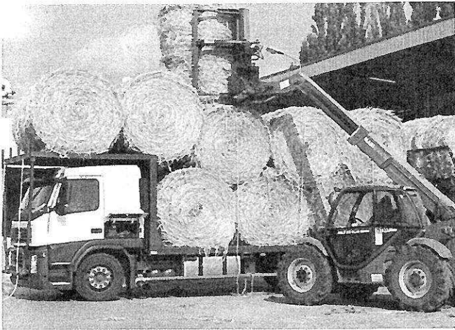
Per Gabelstapler werden die Hanfstrohballen abgeladen. Anschließend werden die Ballen zerteilt, gerüttelt, gesiebt und geschleudert, damit sich die Fasern vom Stengel lösen.
