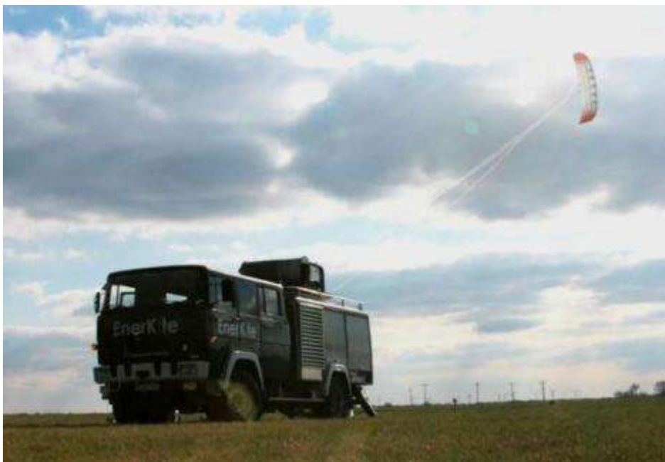
Ein Generator am Boden, den der Drachen über eine Seilwinde in Schwung bringt: So sieht das System der Firma Enerkite aus. (Foto: Enerkite)
