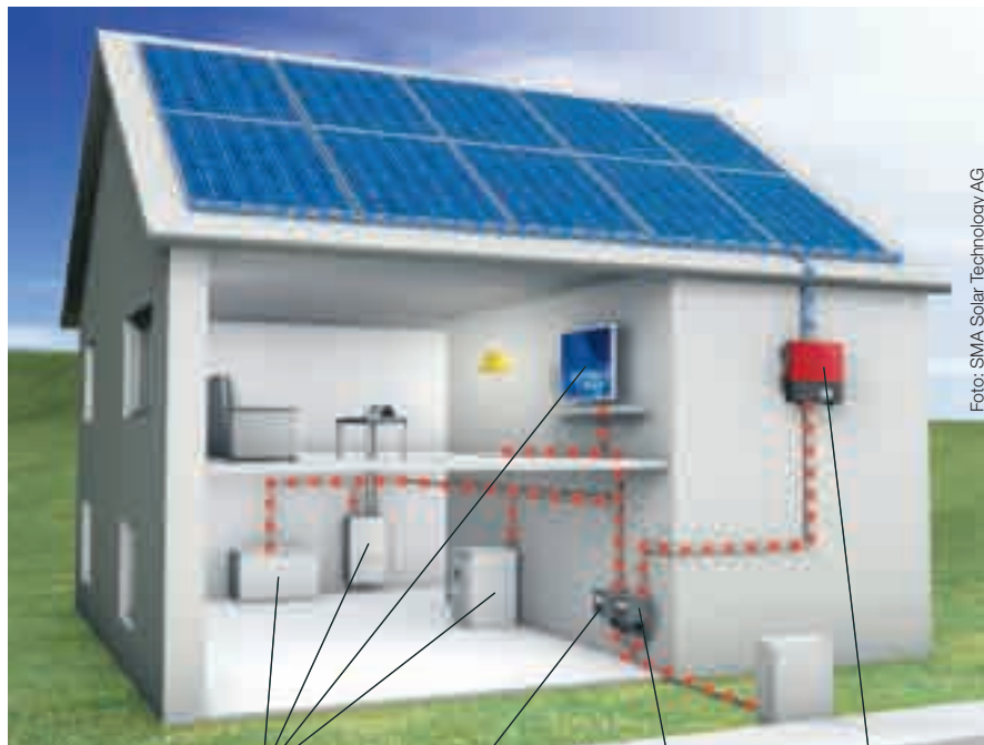
Verbraucher Bezugszähler Einspeisezähler Wechselrichter
