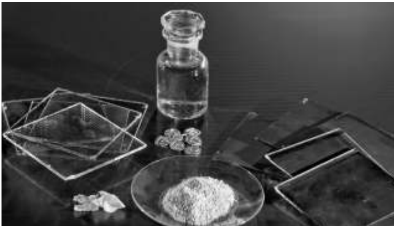
Recycling-Resultat: Nach der Wiederaufbereitung ist das Solarmodul in seine Bestandteile zerlegt, darunter das Abdeckglas, der Kunststoff von der Laminierung, Indium-Metall, Indiumhydroxid (weißes Pulver) und eine gelbliche Lösung aus Kupfer, Indium, Gallium und Selen (Fläschchen).
