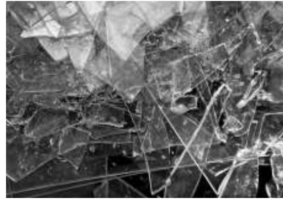
Blankgeputzt: Nach dem Säubern (unten) ist das Glas der Metall-beschichteten CIGS-Modulscherben (oben) wieder so durchsichtig wie vor der Verarbeitung zu Solarzellen.
