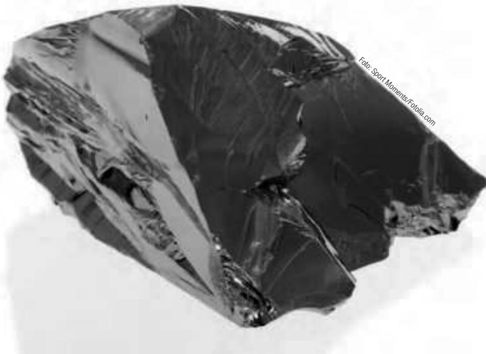
**Begehrter Rohstoff:** Siliciumbrocken werden geschmolzen, zu Blöcken verarbeitet und anschließend in Scheiben gesägt, die zu Solarzellen prozessiert werden.
