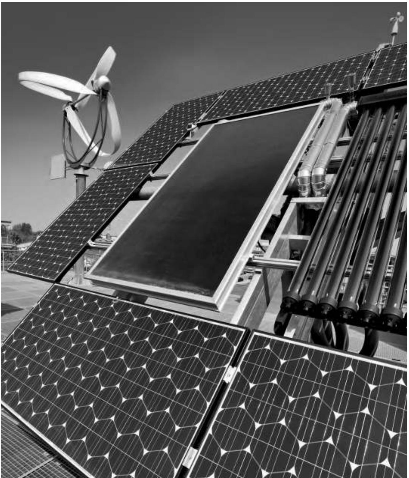
**Vereinte Kräfte:** An einem Versuchsstand der Technischen Universität Cottbus erzeugen ein Windrad, verschiedene Photovoltaik-Module und eine Solarthermieanlage gleichzeitig Strom und Wärme.
