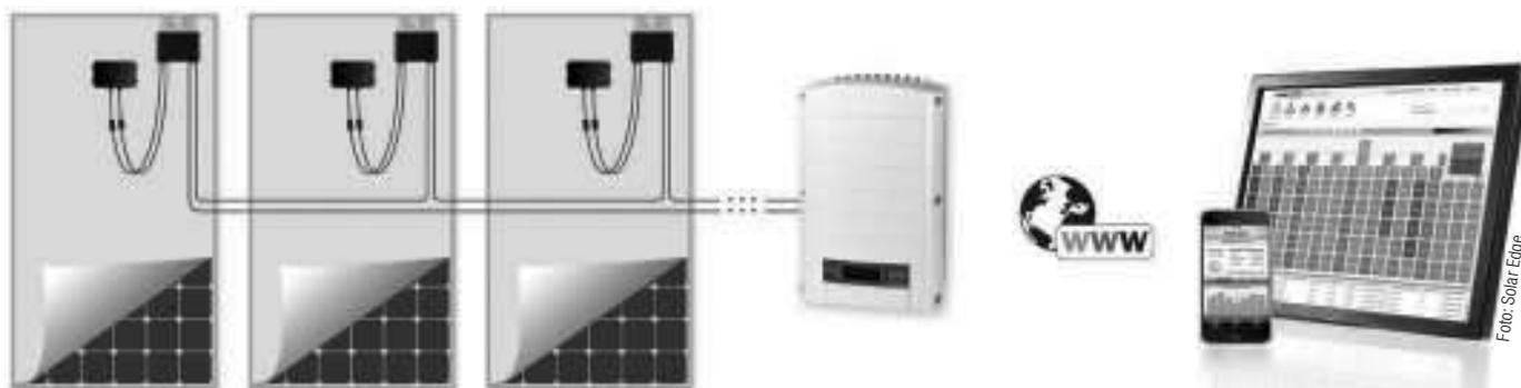
**Überblick:** Der *Power Optimizer* hält jedes einzelne Modul im optimalen Betriebszustand. Die Leistungsdaten spielen sie einem Schnittstellengerät zu, das sie in leicht verständliche Grafiken umwandelt.
