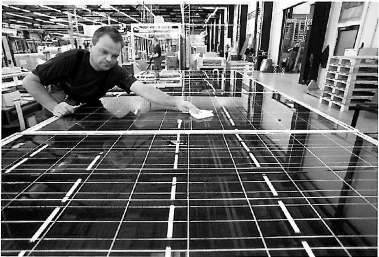
Abb. 3: Glänzende Technik: Neueste Module sehen nicht nur schick aus, sie sind auch hocheffizient – manches Panel erreicht fast schon 20% Wirkungsgrad. Foto: BMU
