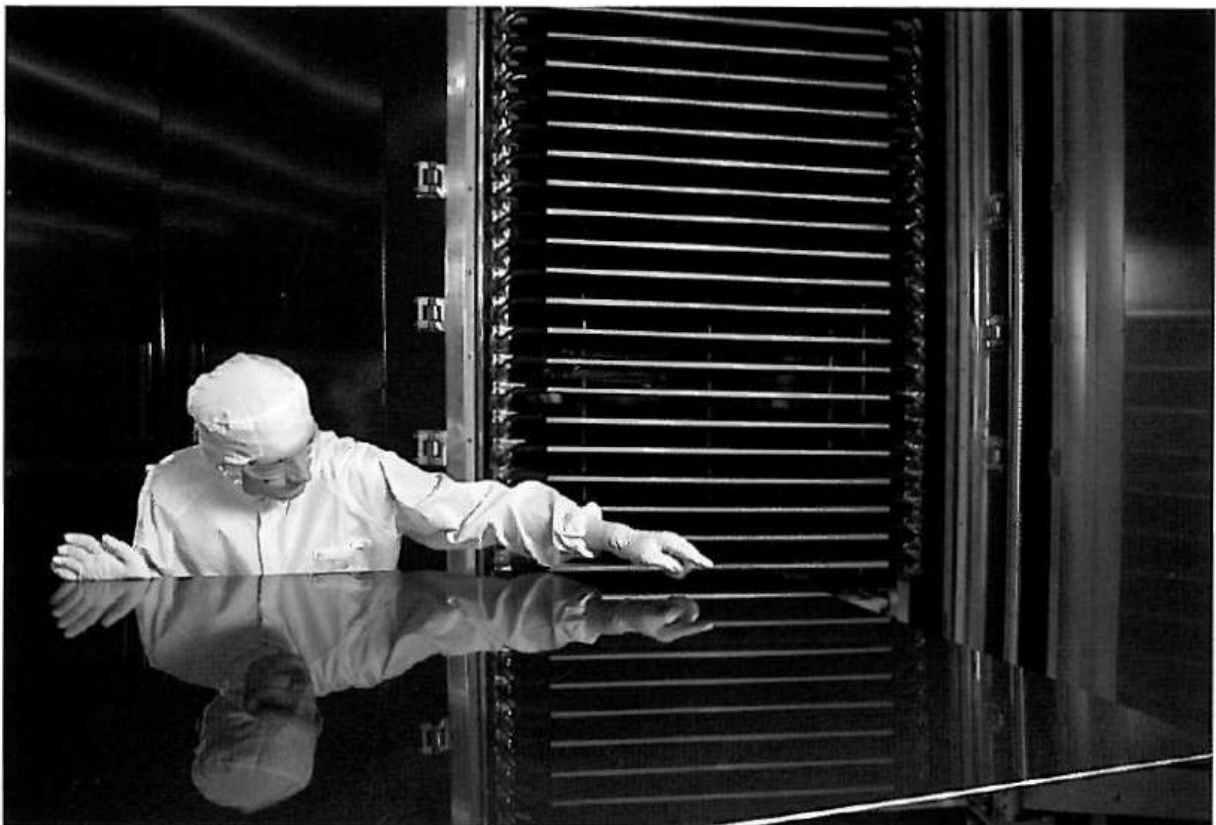
Abb. 4: Qualitätsprüfung: Ein Mitarbeiter der Berliner Firma Inventux nimmt die Oberfläche eines Modules aus Dünnschichtsilizium in Augenschein. Foto: Inventux
