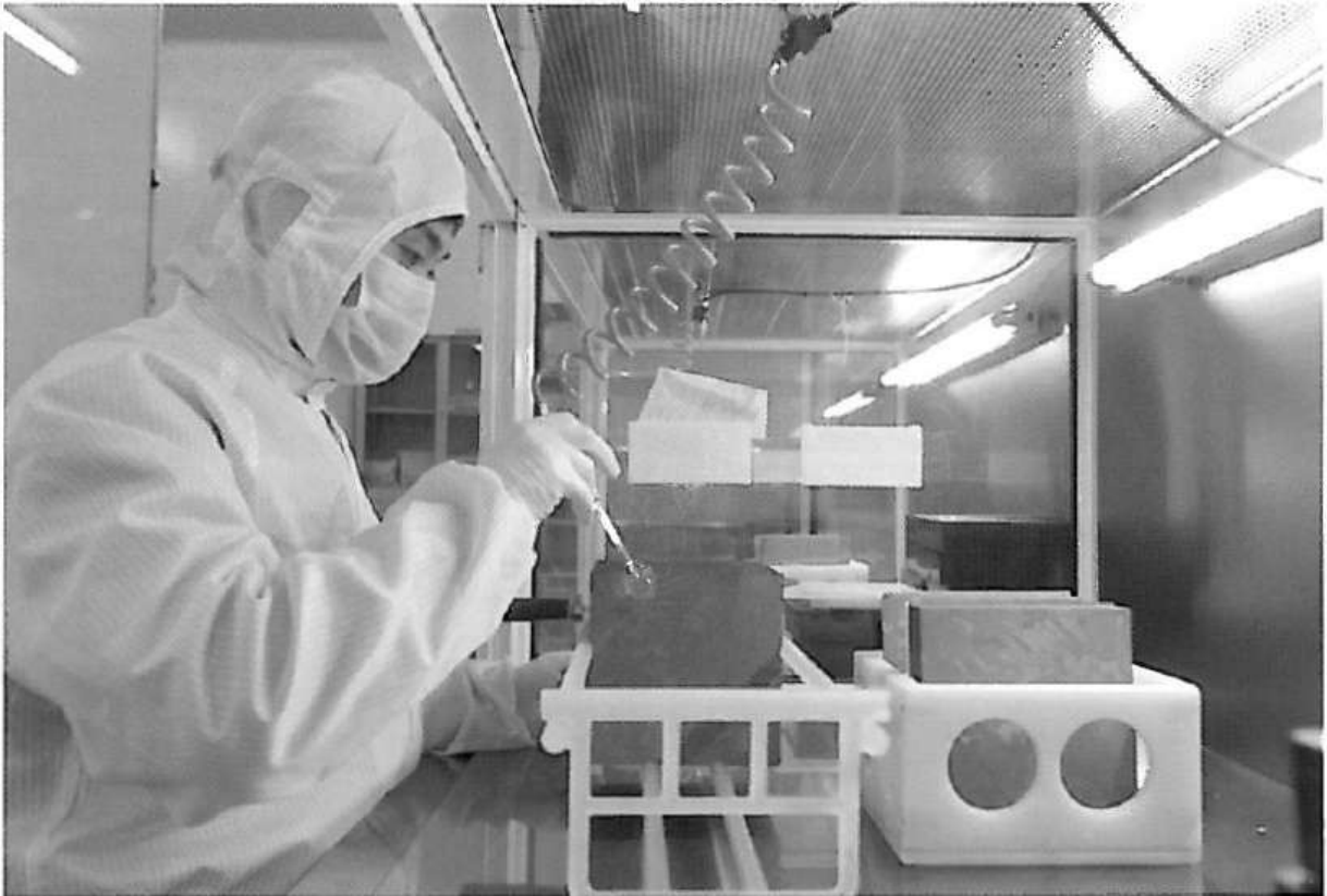
Abb. 1: Halbleitercheck: Je besser die Qualität der Siliziumscheiben ist, desto effizienter werden die Zellen. Deshalb werden die Wafer vor der Fertigung genau inspiziert. Foto: Suntech Power
