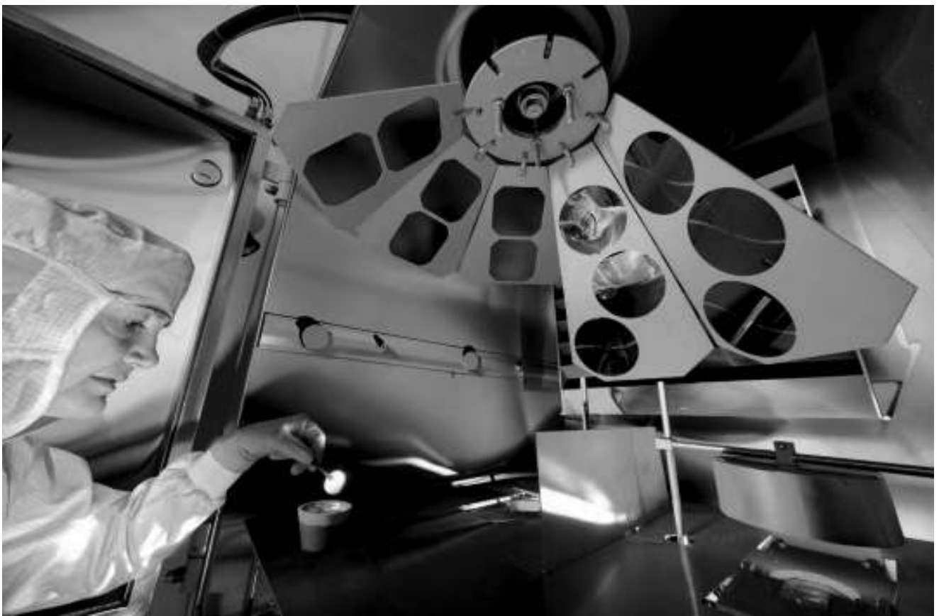
Ein Körnchen Effizienz: Metallbedampfung von Wavern im Reinraum. Mit Aluminium wollen Forscher den Wirkungsgrad erhöhen.
