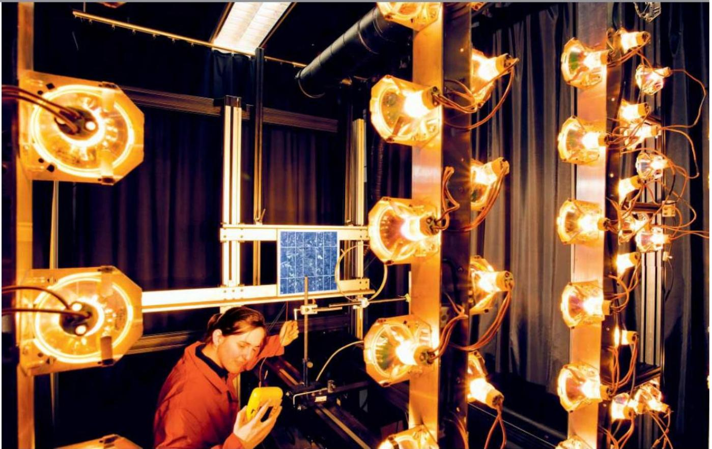
**Labor als Sonnenstudio:** Am Fraunhofer-Institut ISE wird untersucht, wie Solarzellen auf unterschiedliche Licht-Wellenlängen reagieren
