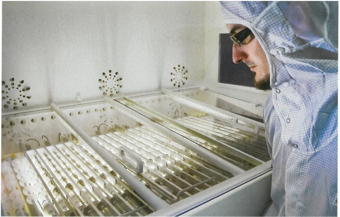
Im Lichtschrank: Im Fraunhofer ISE werden Kontaktgitter durch galvanische Verdickung unter Beleuchtung aufgebracht.
